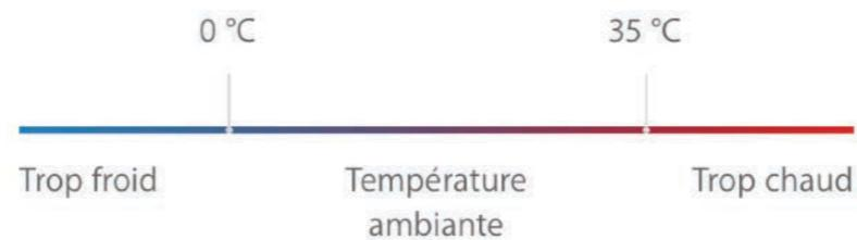
L'iPhone, l'iPad, l'iPod et l'Apple Watch fonctionnent de manière optimale dans une plage de températures comprises entre 0 et 35 °C. Température de rangement : de -20 à 45 °C
